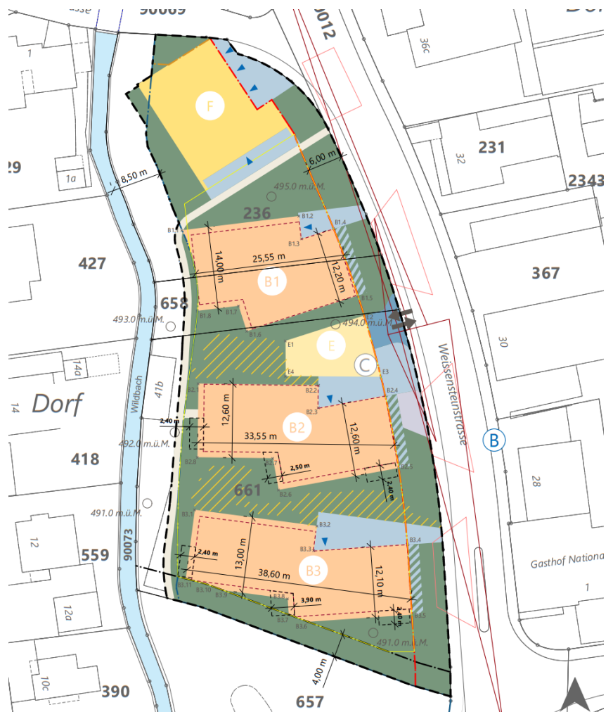
Abbildung 25: Ausschnitt aus dem Situationsplan 1:500 (ohne Legende, Schnitte und Koordinatenliste). Die oberirdischen Baubereiche sind gelb-orange dargestellt, Quelle: Plan-team S AG.
